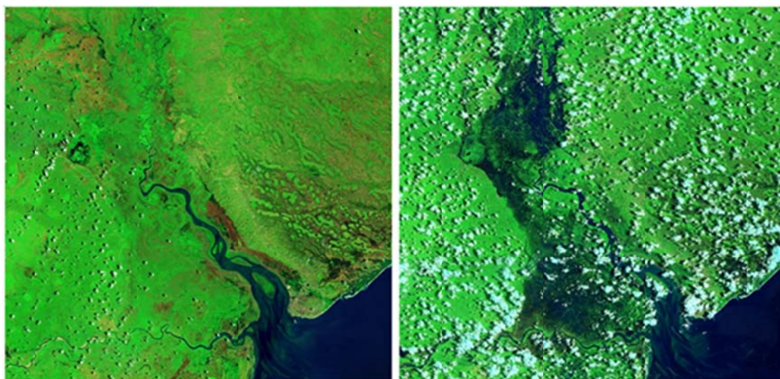
图 5.3 飓风埃洛伊塞在莫桑比克引发的大洪水 (右图暗色区域) (左图影像获取自洪水之前 2019 年 12 月 27 日, 右图获取自洪水发生后的 2020 年 1 月 30 日; 两幅影像都来自于 Landsat8 OLI 传感器并以假彩色合成 (7-5-3 对应 R-G-B 通道))。源自: ( https://earthobservatory.nasa.gov/images/147866/eloise-floods-mozambique )
